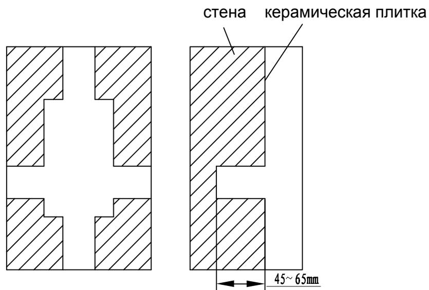
Вырезать внутренний канал в соответствии с реальным продуктом, глубина отверстия составляет от 45 до 65мм.
