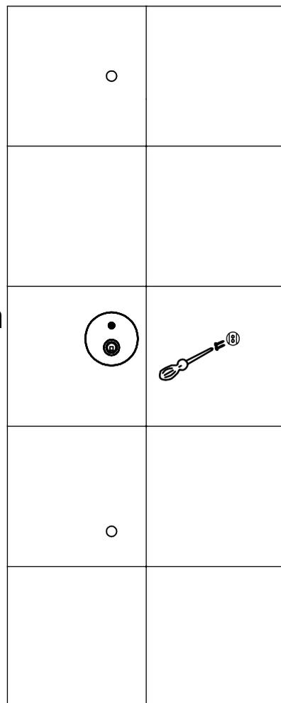
После выреза схемы на плитке стены, убедитесь, что отверстия для душевого кронштейна и душевого шланга соответствуют размеру на месте, установите крышку смесителя, просверлите два отверстия на плитке для держателя для душа.
